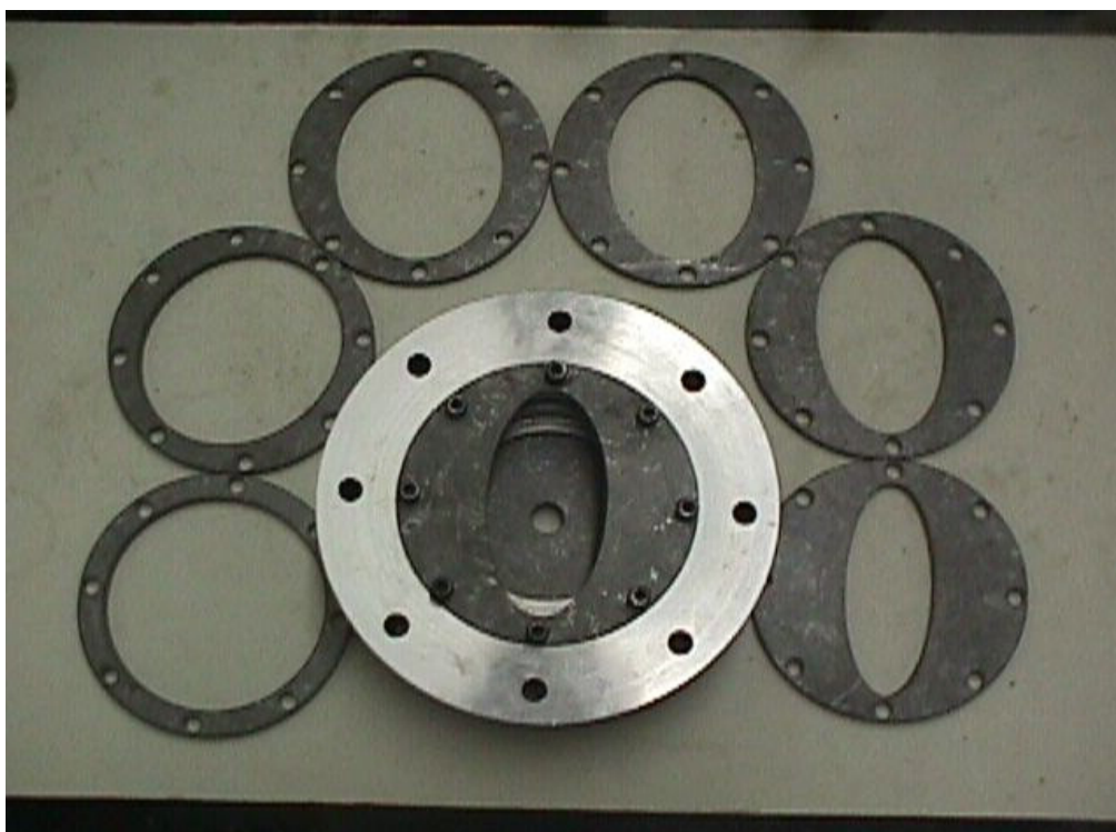
Figura 9.1 – (a) - Dispositivo e corpos de prova do ensaio de expansão hidráulica de chapas (bulging test). (b) Dispositivos de ensaio de expansão hidráulica de chapas metálicas (bulge test) com prensas chapas com prensa chapa circular e elíptico com diferentes razões de raios.
