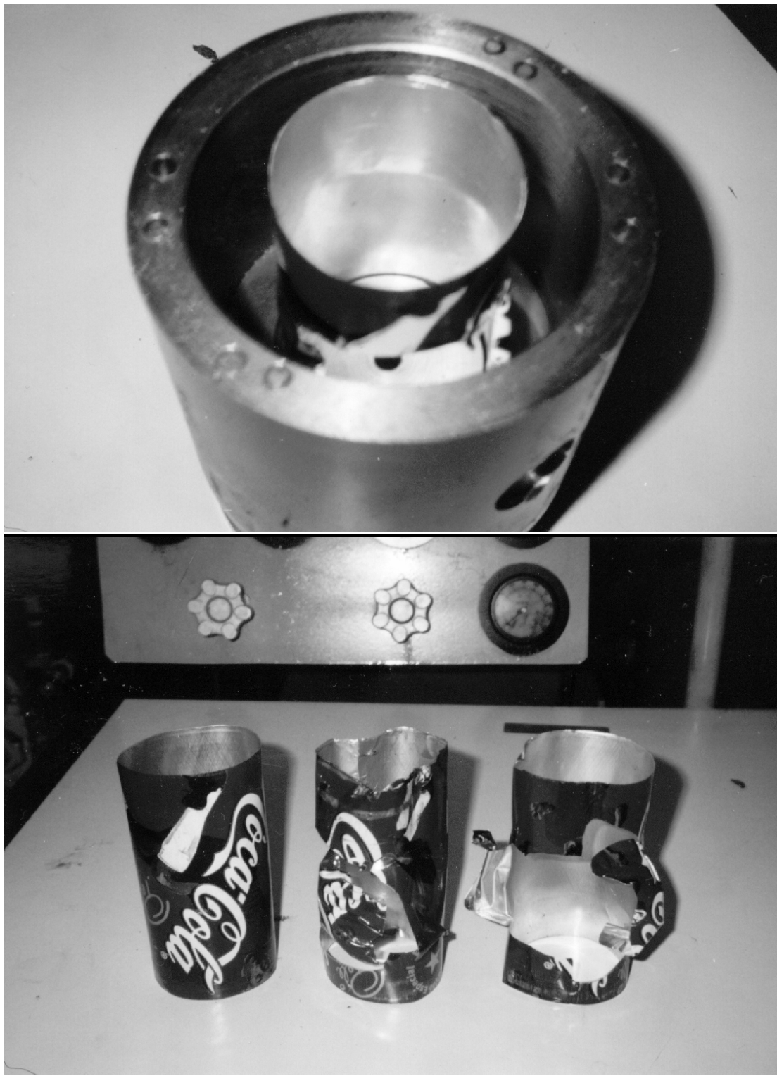
Figura 9.4 - (a) Ferramental aberto após a realização do ensaio (b) Corpos de prova deformados até sua ruptura
