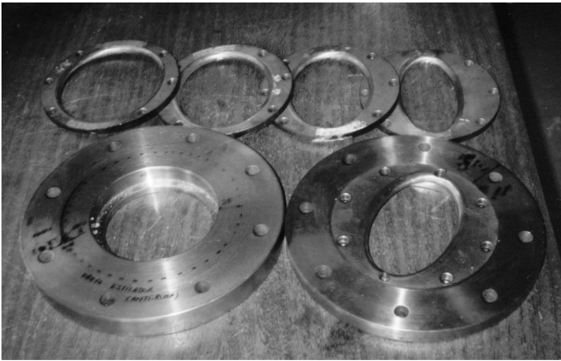
Figura 1.5 - (a) Falha ocorrida em um dos ensaios (tampa da matriz soltou) (b) ferramental de “bulge-test” após pequenas modificações
