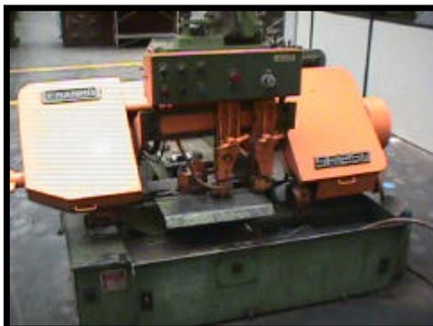
**Figura 3.1.1 – Serra Hidráulica**
