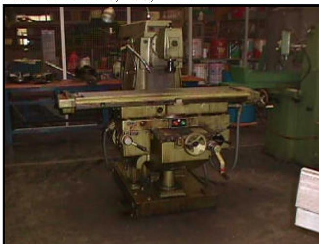
**Figura 3.1.3 – Fresadora Ferramenteira**
