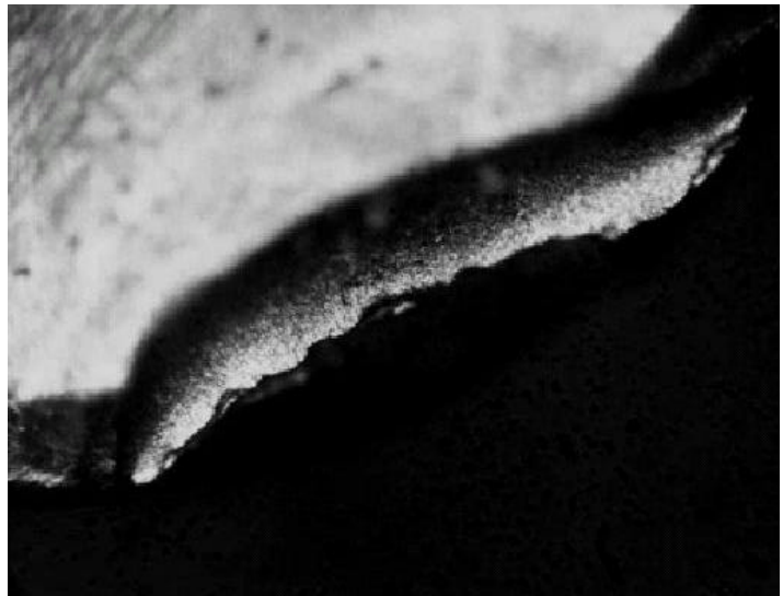
figura 7 – inserto com aresta de corte fraturada
