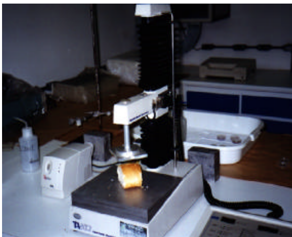
Figura 1 Foto do Analisador de Textura TA-XT2 durante teste de dupla compressão em amostra de pão francês.
