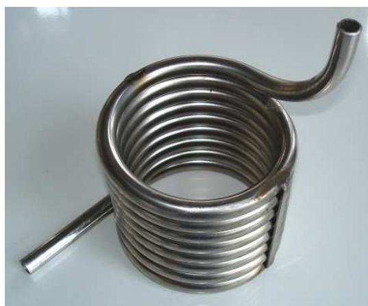
Figura 2 – Tubo de retenção usado para o experimento de DTR (sem o isolamento térmico).
