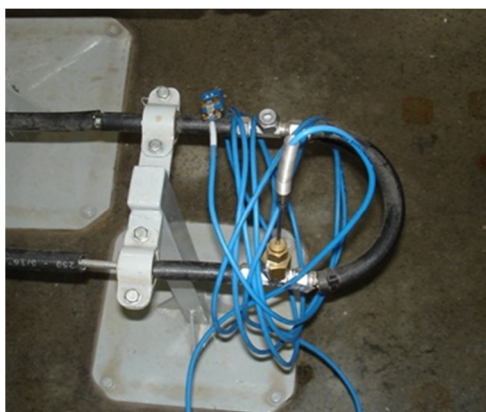
Figura 1 – Termopar inserido no trocador.
