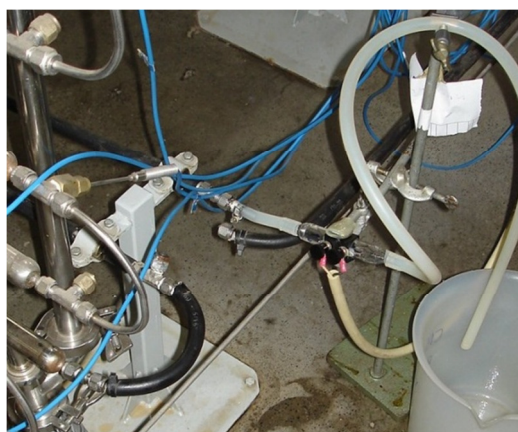
Figura 2 – Aparelhagem montada para ensaio de DTR, detalhe para célula monitora
