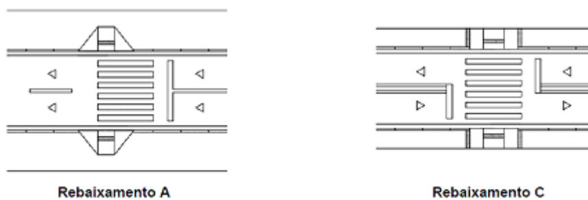
Figura 2-14 - Exemplos de rebaixamentos em meio de quadra (Fonte: ABNT NBR9050 Acessibilidade a edificações, mobiliário, espaços e equipamentos urbanos, 2004)
