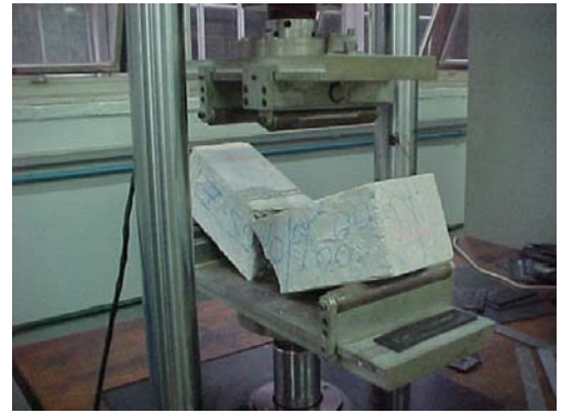
Figura 2: Ensaio à fadiga - ruptura da amostra
