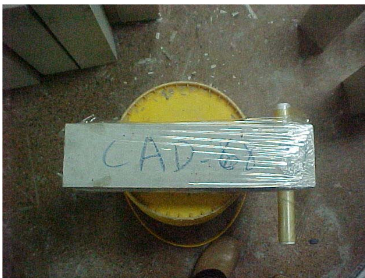
Figura 1 Selagem dos corpos-de-prova com filme PVC
