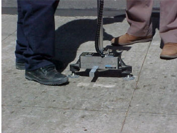
**Figura 2.11** *Dipstick* medindo a Irregularidade Longitudinal no WTUD
