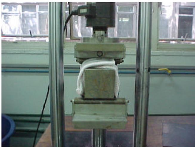
**Figura 2.31** Ensaaios à fadiga vista frontal – amostra saturada.
