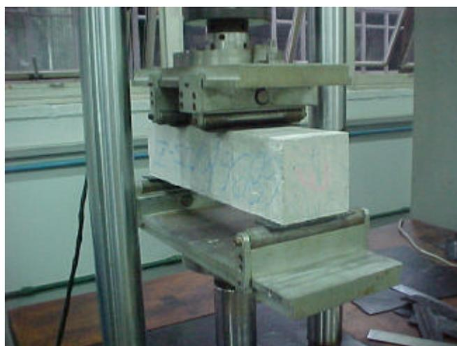
**Figura 2.27** Ensaio à fadiga vista completa – amostra seca.
