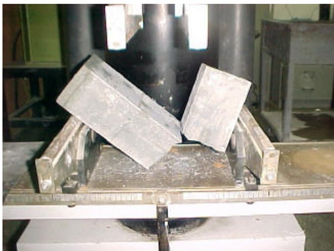
**Figura 2.11** Ruptura à tração na flexão estática do corpo-de-prova de 100 x 100 x 400mm.
