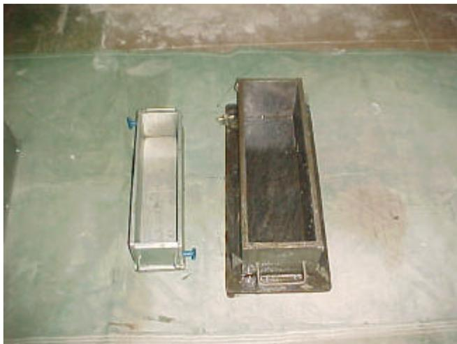
**Figura 2.3** Moldes utilizados para a confecção dos corpos-de-prova nas duas dimensões: 100 x 100 x 400 mm e 150 x 150 x 500 mm.
