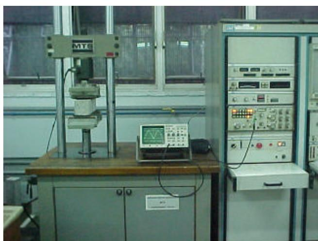
**Figura 2.23** Máquina servo-hidráulica da MTS para ensaios à fadiga.
