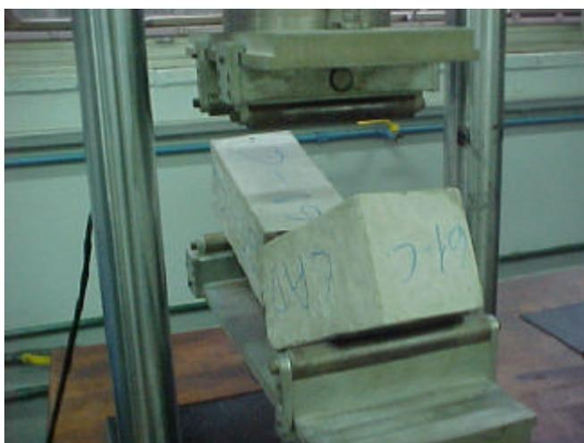
**Figura 2.37** Ensaio à fadiga – ruptura do corpo-de-prova seco – vista completa.
