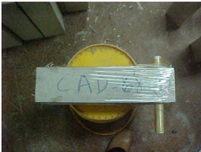
**Figura 2.12** Selagem dos corpos-de-prova com filme PVC.
