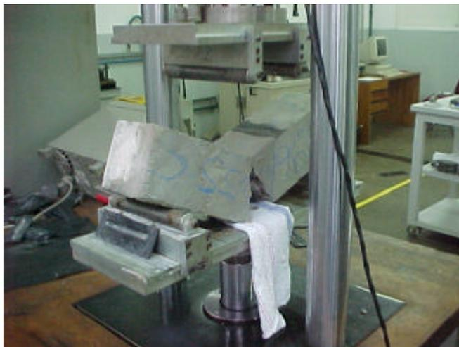
**Figura 2.34** Ensaio à fadiga – ruptura do corpo-de-prova saturado – vista completa.
