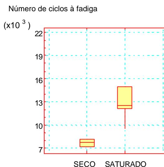
**Figura 4.27** Representação gráfica do teste de hipótese “t” de *Student* para o CAD seco versus saturado com RT = 0,83.
