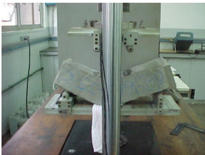
**Figura 2.35** Ensaio à fadiga – ruptura do corpo-de-prova saturado – vista lateral.
