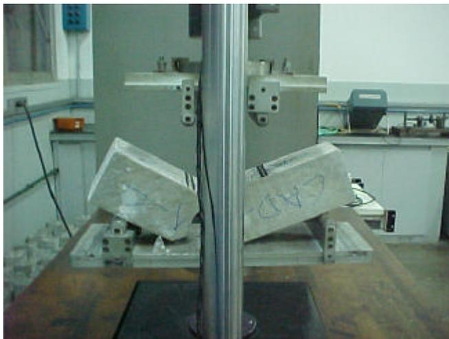
**Figura 2.36** Ensaio à fadiga – ruptura do corpo-de-prova seco – vista lateral.
