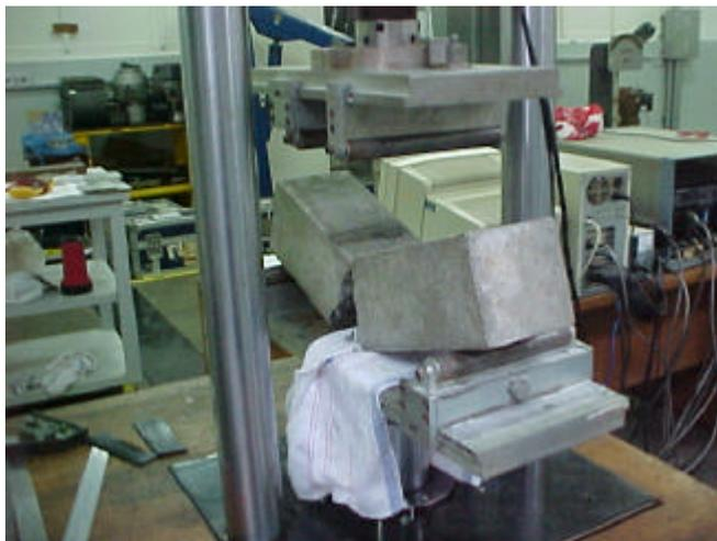
**Figura 2.39** Ensaaios à fadiga vista completa – amostra saturada.
