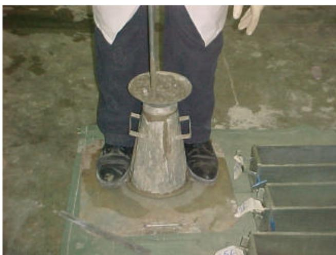
**Figura 2.5** Ensaio de abatimento do tronco-de-cone – NBR NM 67/98.
