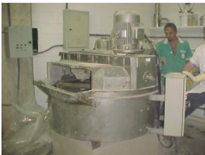
**Figura 2.4** Betoneira de eixo vertical com capacidade de 300 L de concreto – ABCP.
