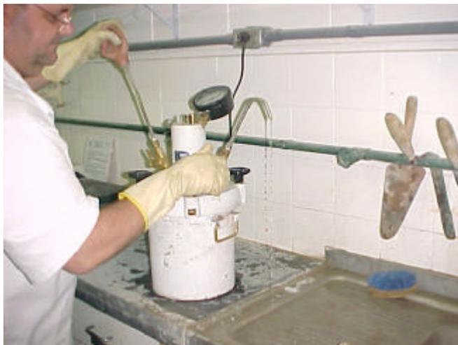
**Figura 2.6** Ensaio de teor de ar incorporado – NBR NM 47/95.
