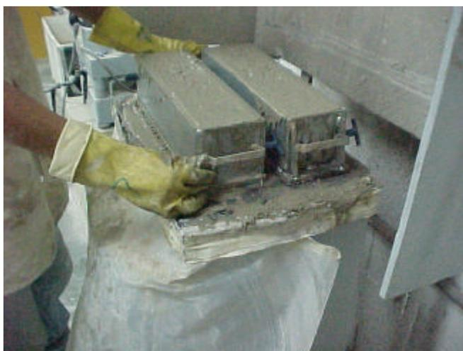
**Figura 2.7** Corpo-de-prova de 100 x 100 x 400 mm em mesa vibratória.
