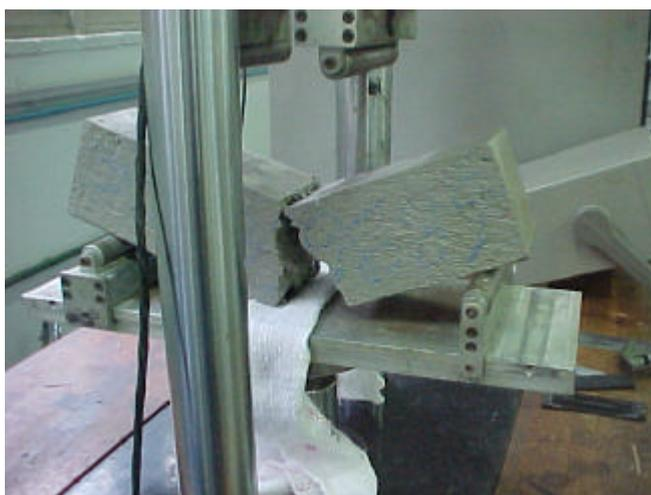
**Figura 2.38** Ensaio à fadiga vista lateral – amostra saturada.
