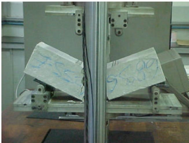
**Figura 2.29** Ensaio à fadiga – ruptura do corpo-de-prova seco – vista lateral.
