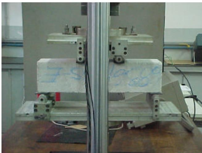
**Figura 2.26** Ensaio à fadiga vista lateral – amostra seca.
