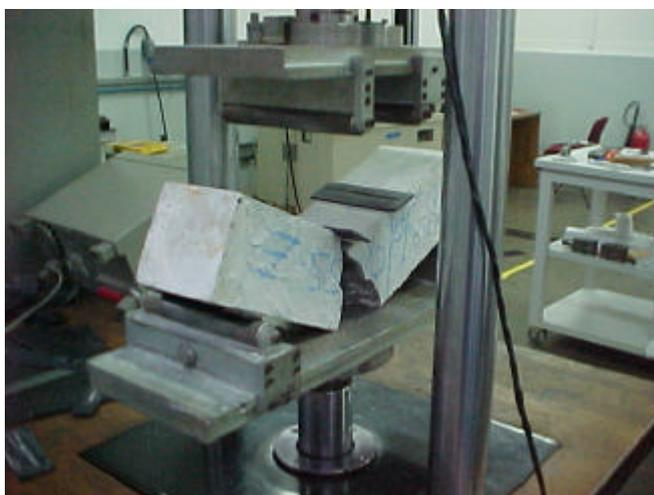
**Figura 2.28** Ensaio à fadiga – ruptura do corpo-de-prova seco – vista completa.
