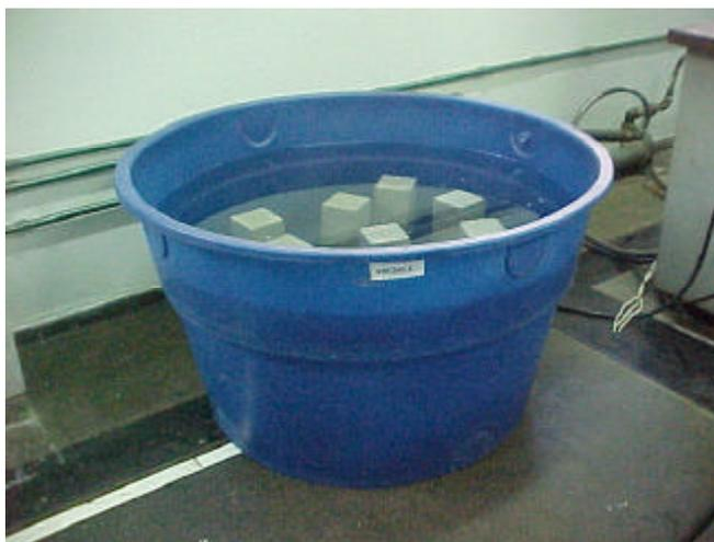
**Figura 2.30** Corpos-de-prova imersos em tanque com água.
